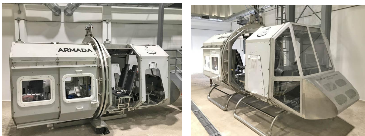
Figura 1. Simulador de egreso subacuático
